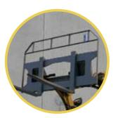
Possibilità di sostituzione dente per pallet con puntale per balloni (e viceversa) su tutti i modelli FPP/FRP
