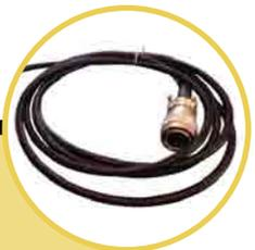
**Connettore a 14 pin:** connette il distributore elettroidraulico direttamente ai comandi interno cabina dello skid, pertanto le funzioni idrauliche vengono comandate da pulsanti e manipolatori del mezzo portante (verificare se di tipo on/off o proporzionali)
